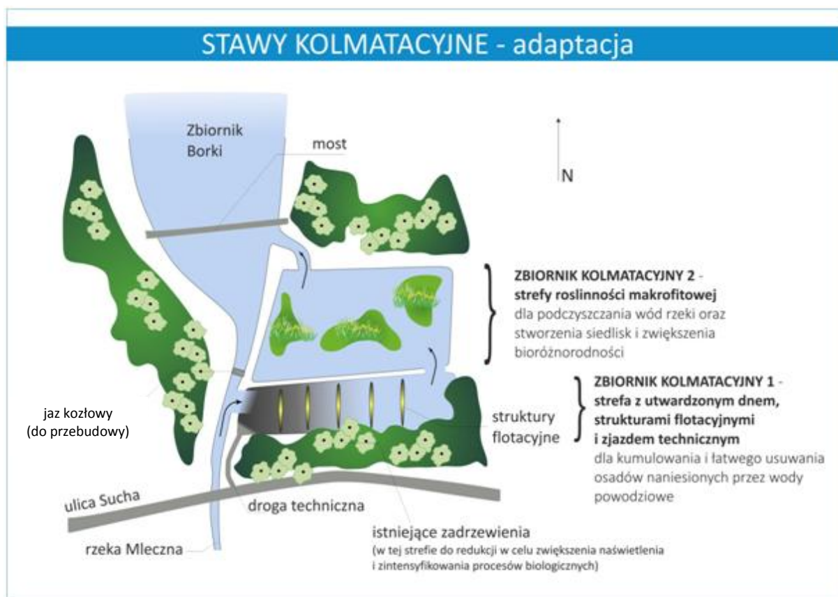
Rycina 7 Schemat przedstawiający rozwiązania dla zwiększenia efektywności oczyszczania wody w stawach kolmatacyjnych przy zbiorniku Borki w Radomiu (źródło: opracowanie własne na podstawie [7]).
